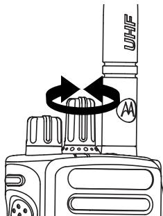
Po żądanej strefy (jeśli w radiotelefonie jest wiele stref) przestaw pokrętło wyboru kanału wybierz typ połączenia.
